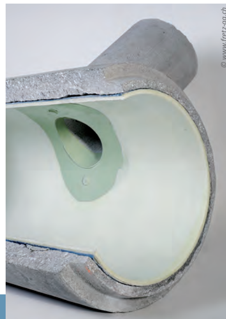
Das alte Rohr wurde mit einem Inliner saniert.
